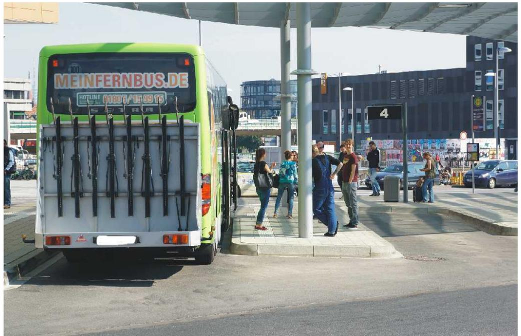
Abb. 86 Bus mit Fahrradvorrichtung
