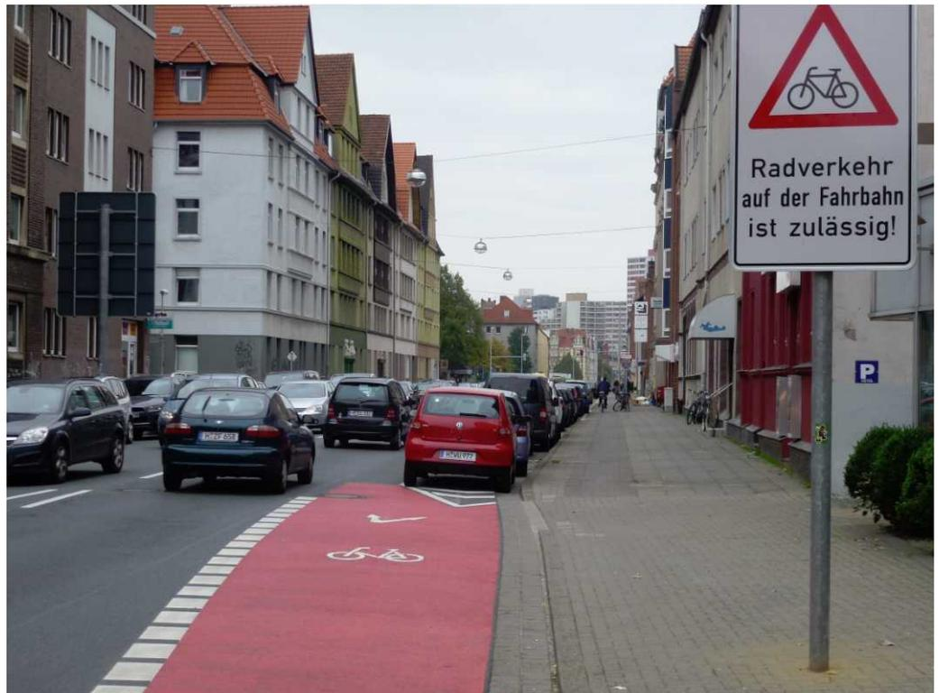
Abb. 48 Verkehrsschild „Radverkehr auf der Fahrbahn ist zulässig!“
