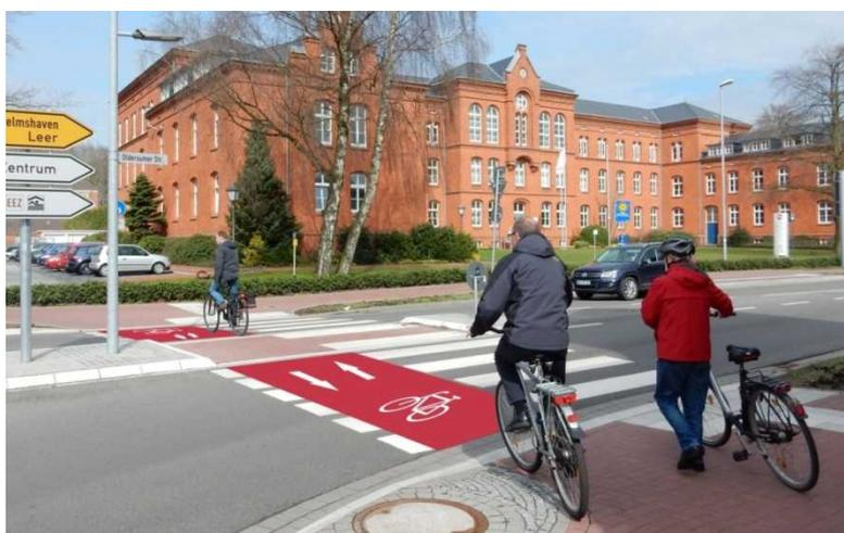
Abb. 70 Regelkonforme Markierung an Kreisverkehren
