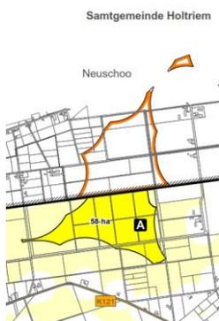
Die Potenzialfläche zur Erstbelegung von Windanlagen im Nordwesten von Aurich umfasst rund 58 ha. Drei Windenergieanlagen sind derzeit in Planung (Stand 2021). Insgesamt bietet die Fläche Platz für 6 Windenergieanlagen. Somit könnten 14,1 MW Leistung mit einem Ertragspotenzial von 42.300 MWh auf dieser Fläche installiert werden.
