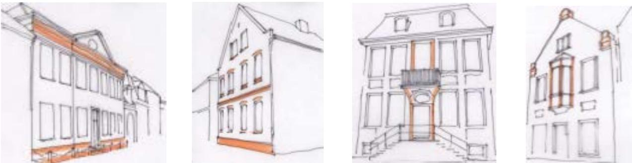
Abb. 6: Beispiele für horizontale und vertikale Profilierungen in den Fassaden<sup>3</sup>
