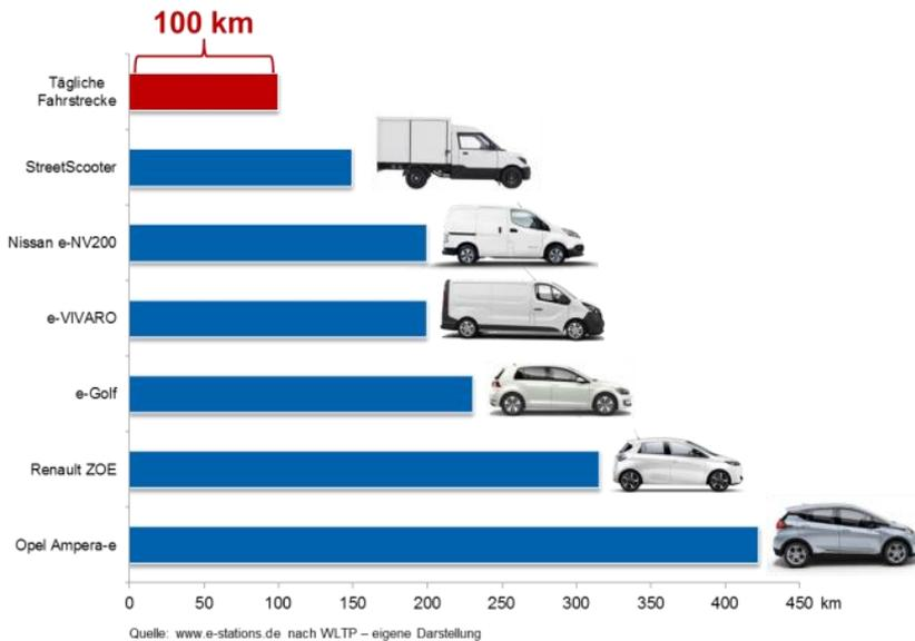
**Abbildung 99: Reichweiten etablierter (4-5 jähriger) Elektrofahrzeugmodelle nach WLTP**
