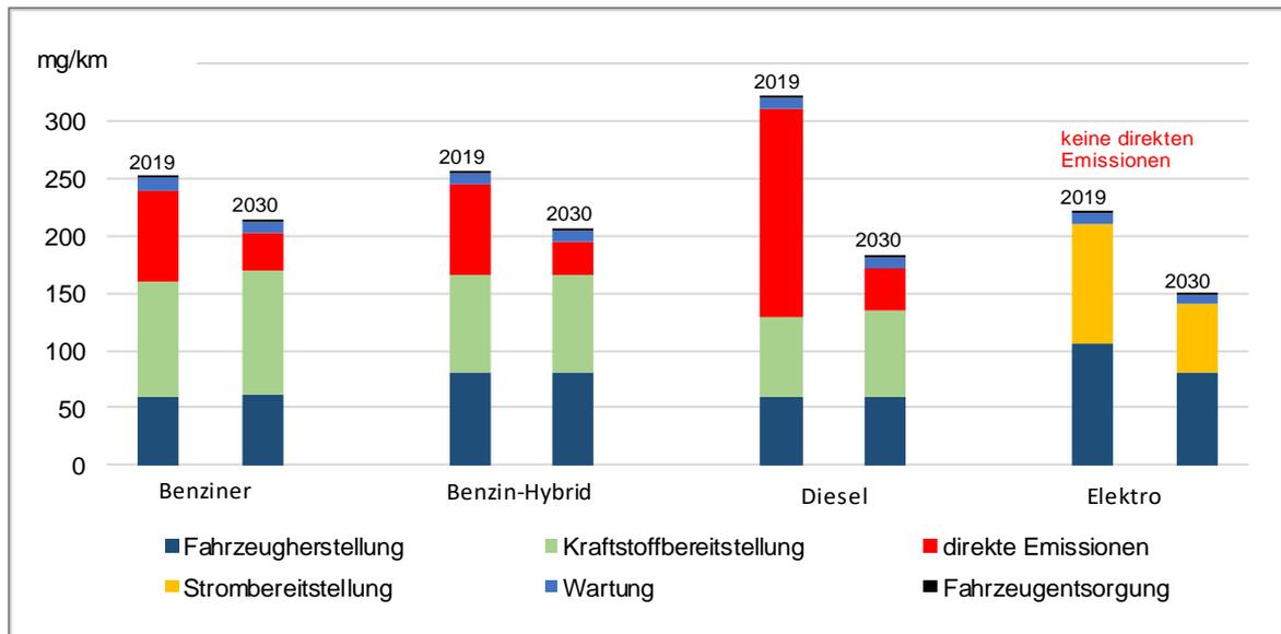
**Abbildung 6: Stickoxidemissionen über den Gesamtlebenszyklus verschiedener angetriebener Fahrzeuge in Milligramm pro Kilometer (frei nach <sup>32</sup>)**
