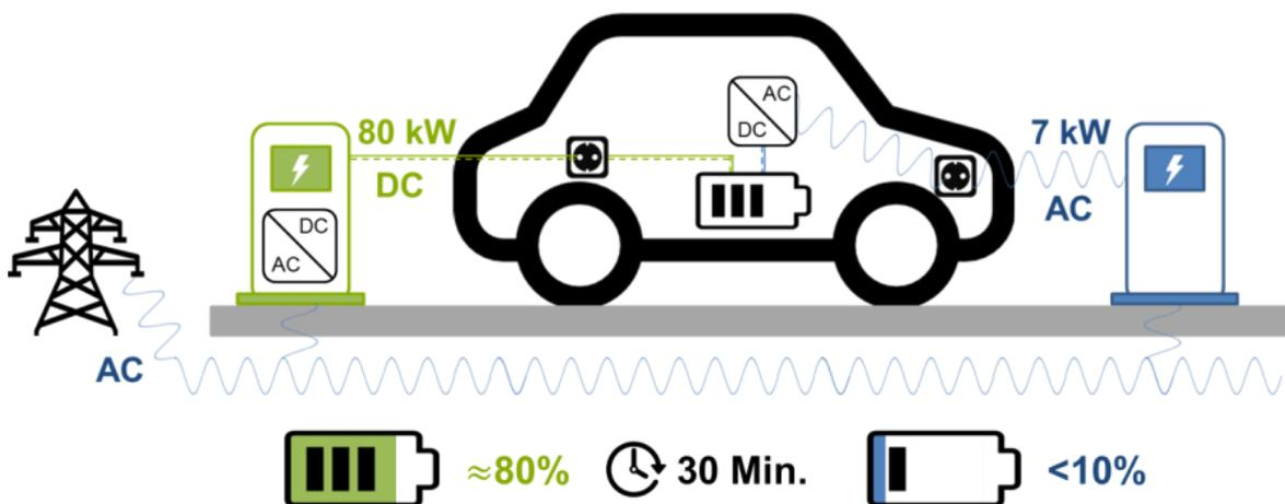
**Abbildung 7: Stark vereinfachte Darstellung der Unterschiede zwischen AC und DC beim Ladevorgang mit heutiger Technik**
