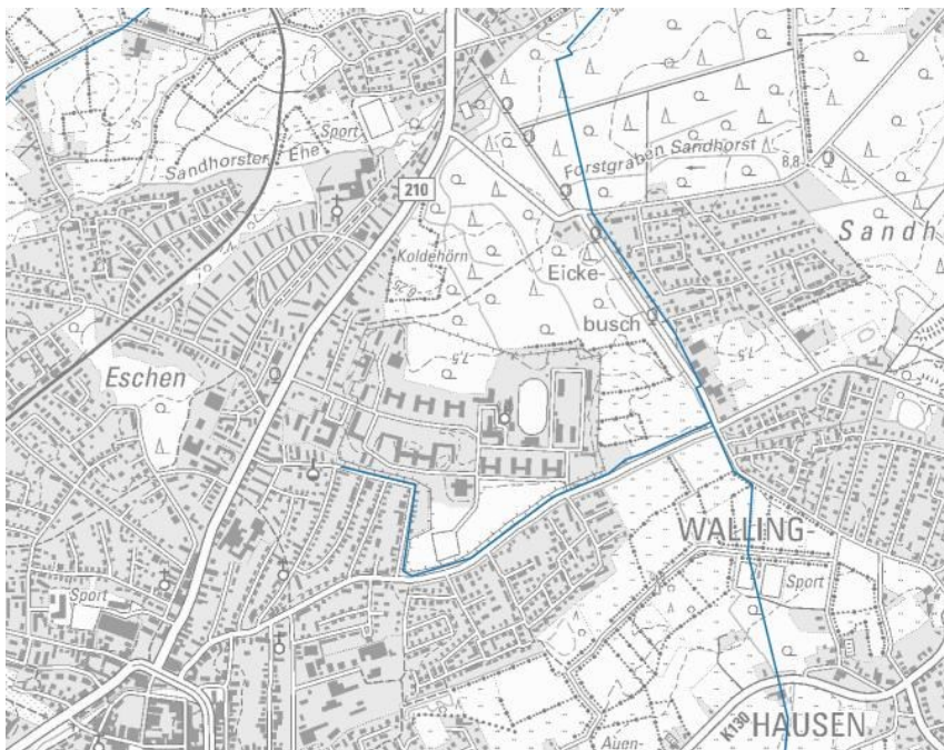
Abb. 20 Ausschnitt städtisches Versorgungsnetz (Wasser-Hauptleitung)
