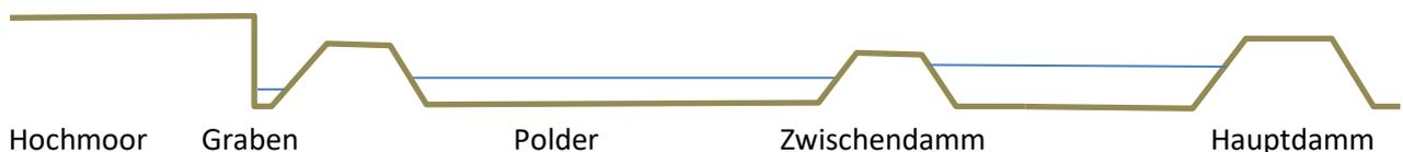
**Abb. 7:** Schematischer Querschnitt durch das UG mit zwei Zwischendämmen und Hauptdamm
