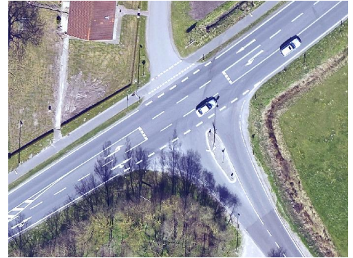
Fehlende Querungshilfe ( Abzweig Esenser Str./Spekendorfer Str.)
