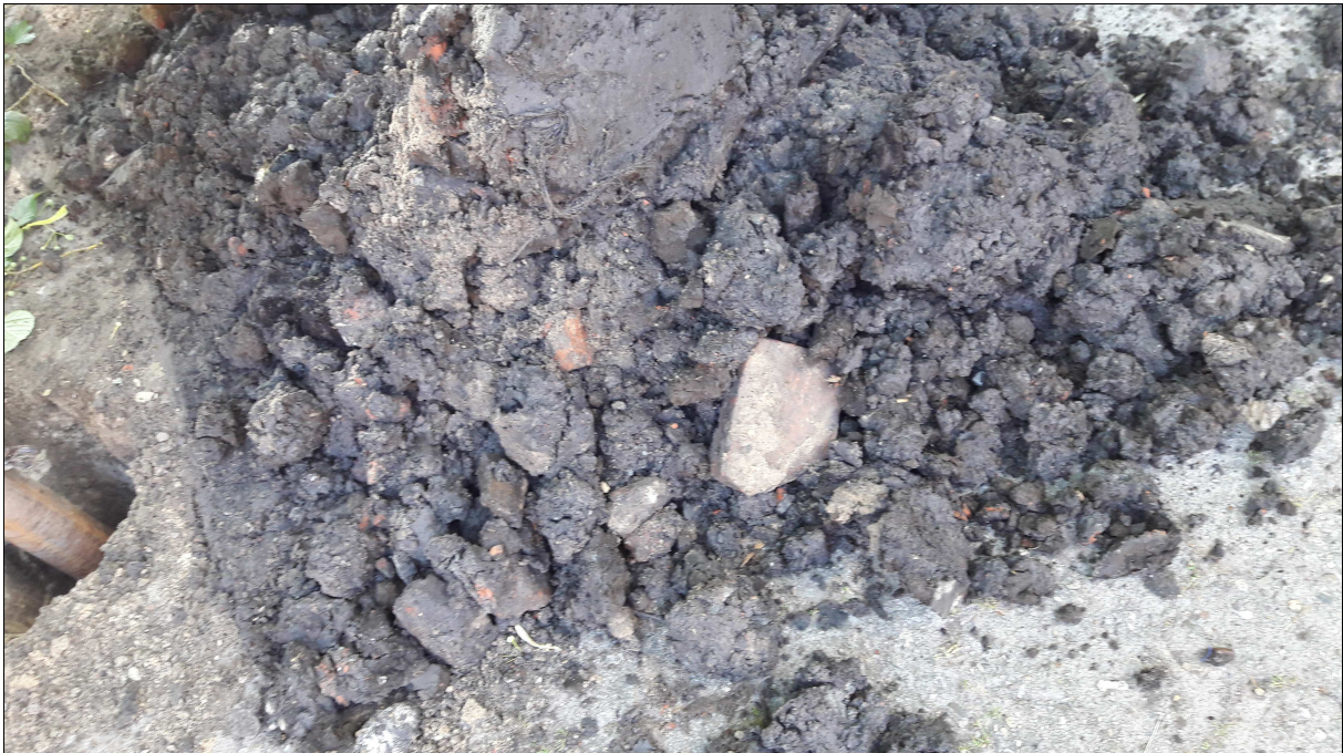
Foto 3: Bohrgut: Boden mit Bauschuttresten
