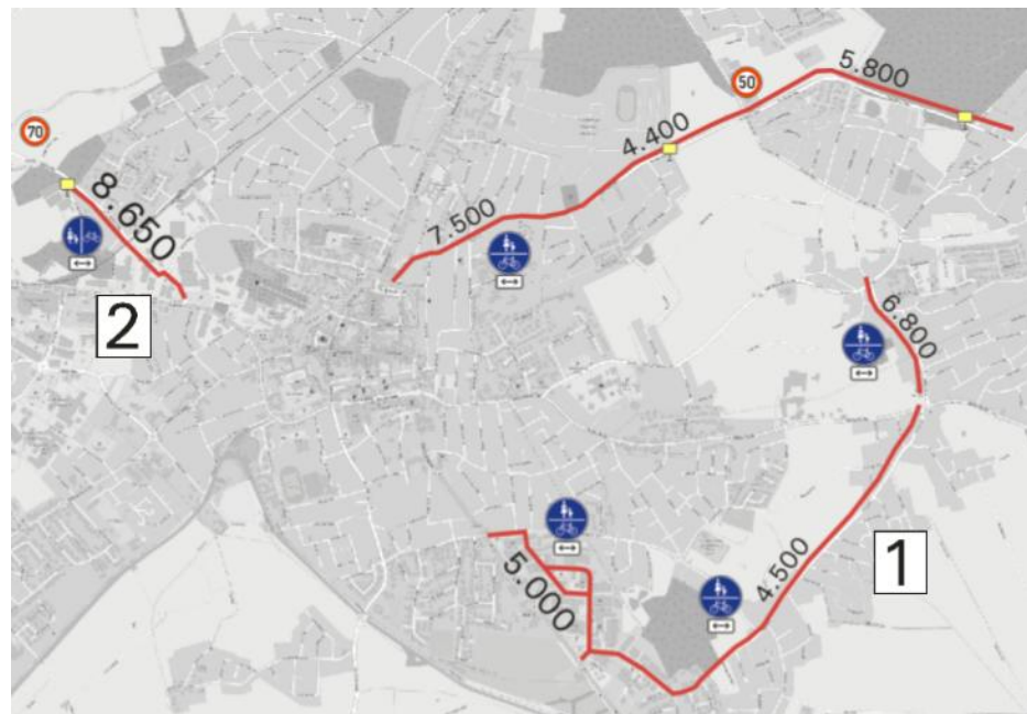
Abb. 35 Strecken mit nicht ERA-konformer Radverkehrsführung
