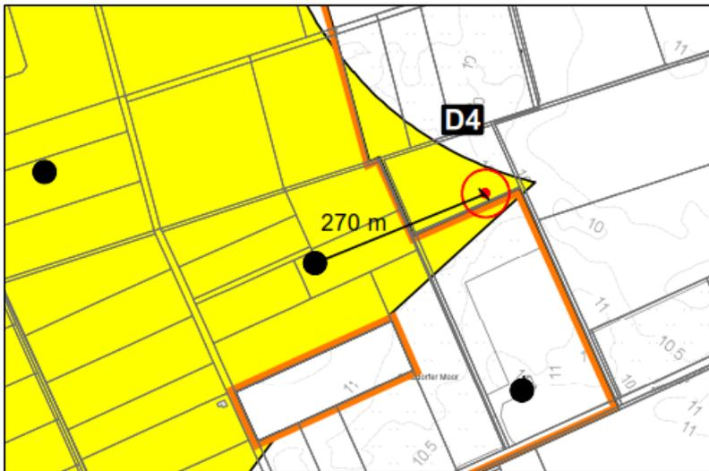
Teilfläche D4 stellt eine östliche Arrondierung des bestehenden Windparks dar. Der Flächenzuschnitt ist Dreiecks-ähnlich mit Abmessungen zwischen rd. 200 - 300 m. Die Möglichkeiten, eine zusätzliche WEA innerhalb der Teilfläche zu platzieren, sind durch die nächstgelegene Bestands-WEA wie auch die geringe Flächengröße deutlich eingeschränkt (vgl. vorstehende Beispiel-Abbildung).
