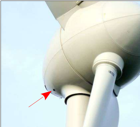
Abbildung 2: Einbauort des Mikrofons am Beispiel der E-53
